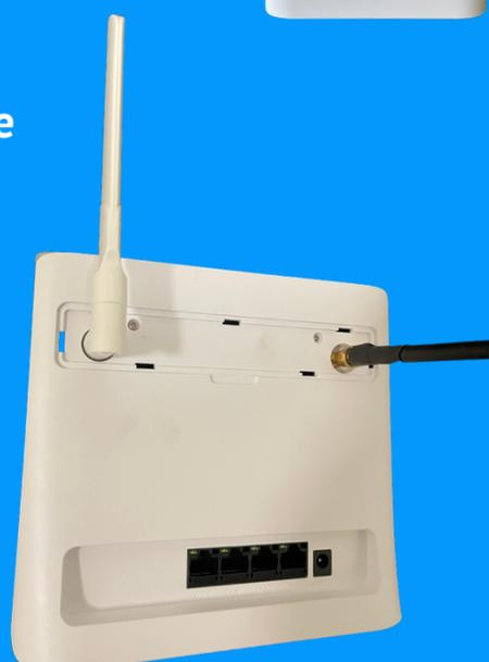
Una vez instalada la antena y el cable coaxial de la antena se encuentre conectado en al módem
