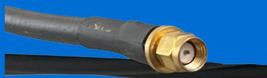
**PASO 2.-** El Módem LTE exclusivo del servicio Arlonet Extreme tiene dos antenas, deberás desconectar la antena del lado derecho y en su lugar conectar la antena extreme con el conector SMA del cable
